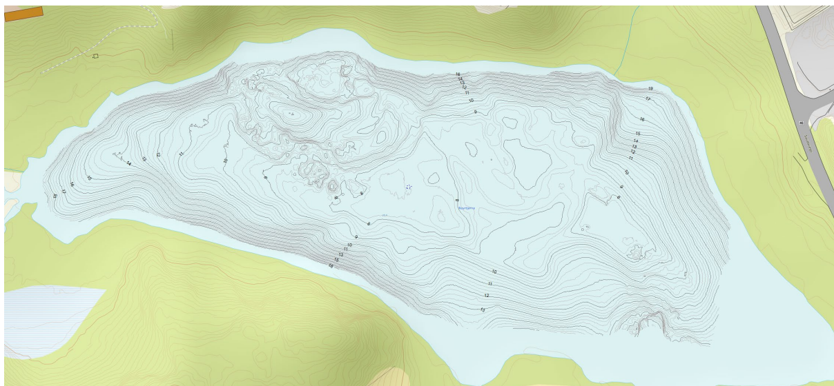
Figur 2 Bunnmodell. Dybder 0-13 meter
